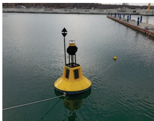
Фиг. 2. ХАЛ (горе) и носещия измервателен морски буй (долу) преди позиционирането му.
