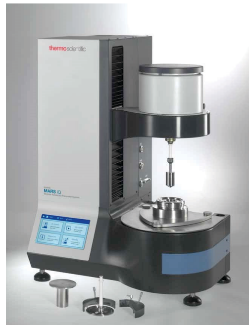
Фиг. 2. Експериментална постановка за измерване на вискозитета.
