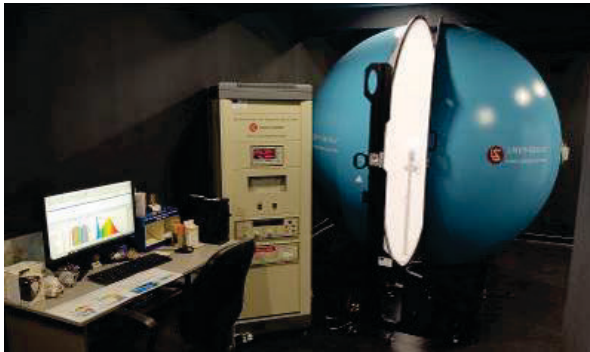
Фиг. 2. Външен вид на измервателния комплект LMS-9000B с интегриращата сфера
