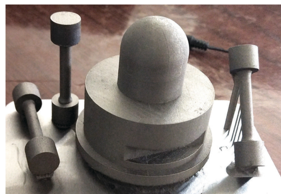
Фиг. 6. Детайл „Сърце-дюза“, изработен на 3D принтер за метал ProX DMP200
