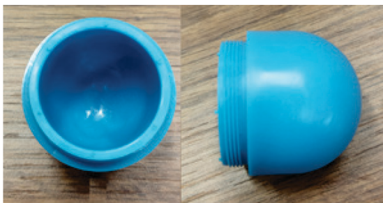
Фиг. 7. Детайл от РС, произведен чрез инжекционно формование с шприцформа със специална temperираща система
