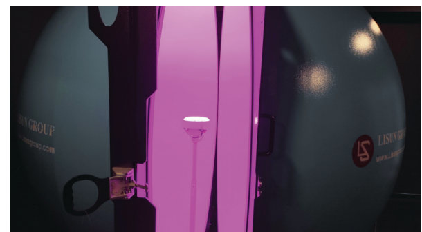
Фиг. 11. Измерване на спектрално разпределение на оранжев LED осветител
